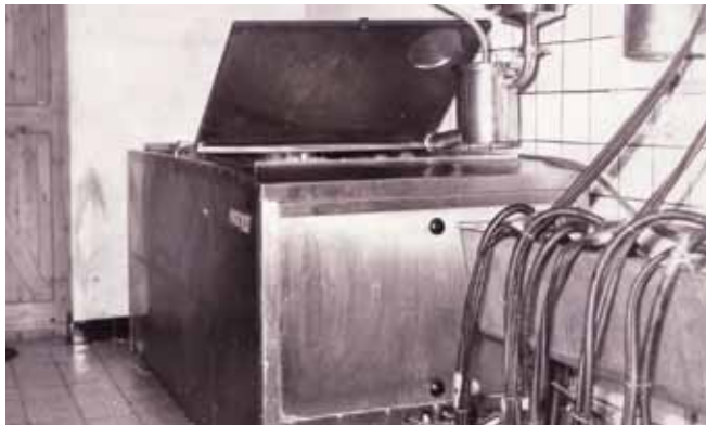
Melkkoeltank, 1970. De introductie van de melkkoeltank, gekoppeld aan de rijdende melkontvangst, was een eerste stap naar een professionelere structuur in de zuivelsector.
